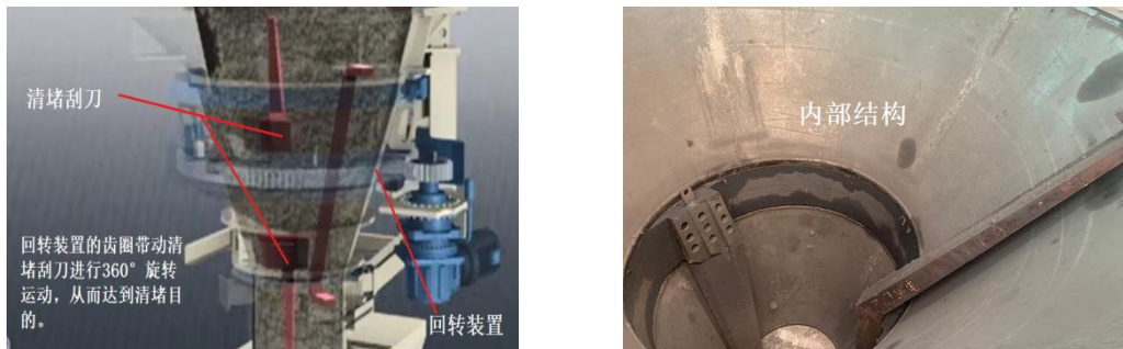
图 2、3 回转式清堵装置工作原理示意
